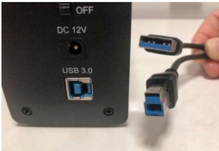
コピー先の外付け HDD のコネクタはこちらの MicroUSB Type-B Super Speed です。
