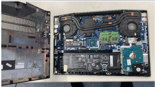
写真は片手だが、両手で同時にピンを開くとメモリの上側が手前に浮き上がる。
