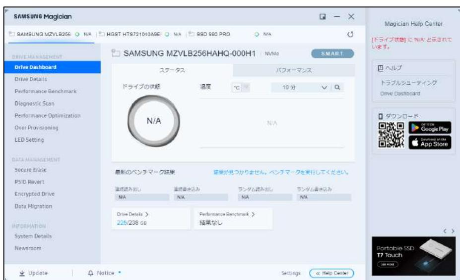
現在 NVMe で接続されている 256GB の SSD を選択して、Data Migration を選択し、ターゲットドライブを新しい 2TB の SSD にする。※なお、12TB の外付け HDD が接続されていた状態でソフトを立ち上げると、新 SSD が表示されなかったので、外付け HDD を取り外してから、ソフトを起動しなおした。
