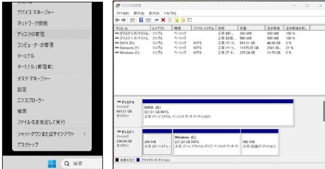
ディスクの管理のディスク 3 が新しい SSD であることが分かったので、それを選択して、下図のように、GPT でディスクの初期化をする。
