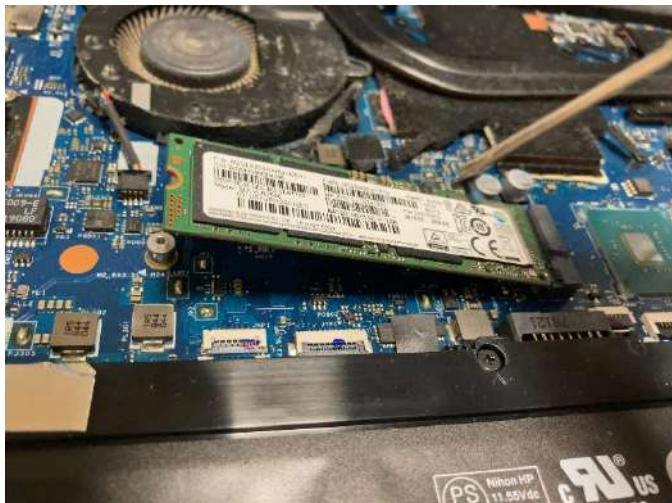
新しい SSD を取り付けて、裏ブタを閉じて、ねじを締める。
